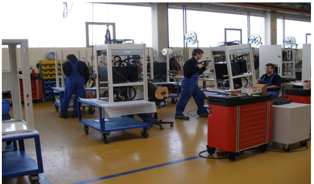
Abbildung: Pilotlinie in Taktmontage auf vier Stationen in Gruppenarbeit.
